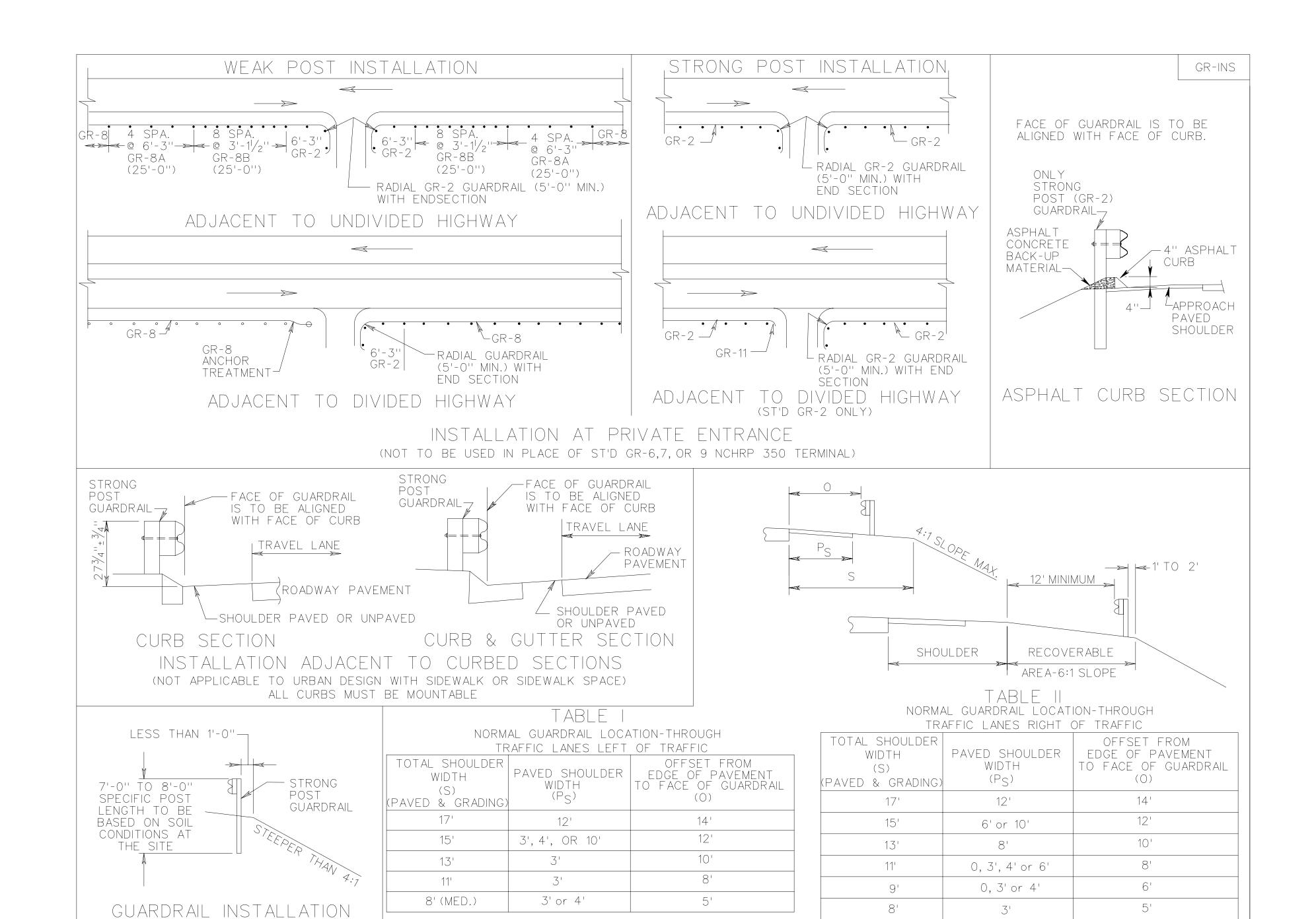
W BEAM GUARDRAIL INSTALLATION CRITERIA
