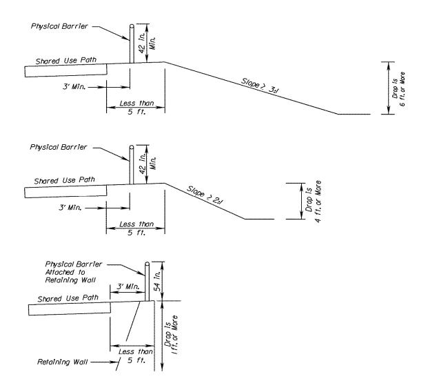
FIGURE A-5-6 PHYSICAL BARRIER FOR SHARED-USE PATH
