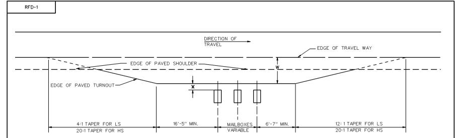
LS - A MINIMUM DESIGN FOR ROADS CARRYING LOW-SPEED TRAFFIC AND FOR LOCAL AND COLLECTOR ROADS.
