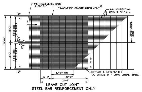
\* LONGITUDINAL STEEL TO CONTINUE THROUGH JOINT.
