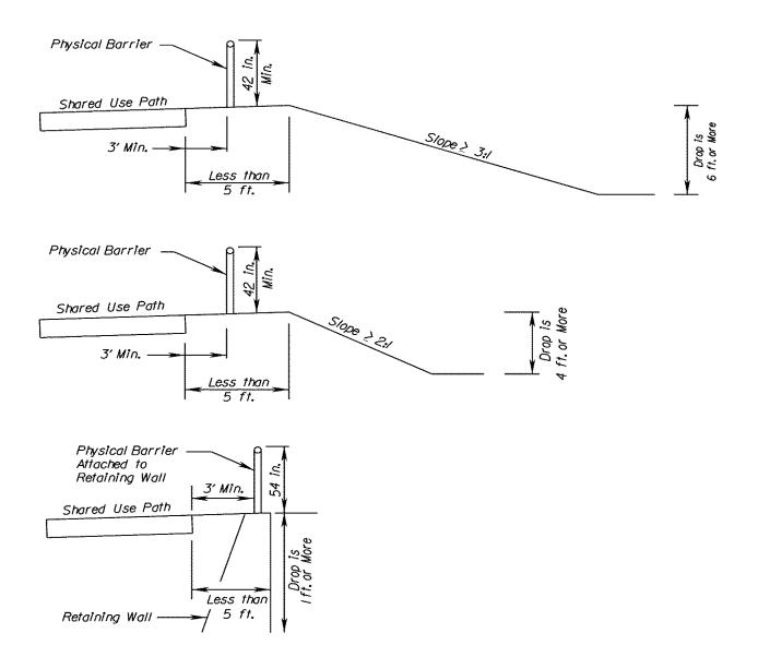
FIGURE A-5-6 PHYSICAL BARRIER FOR SHARED-USE PATH
