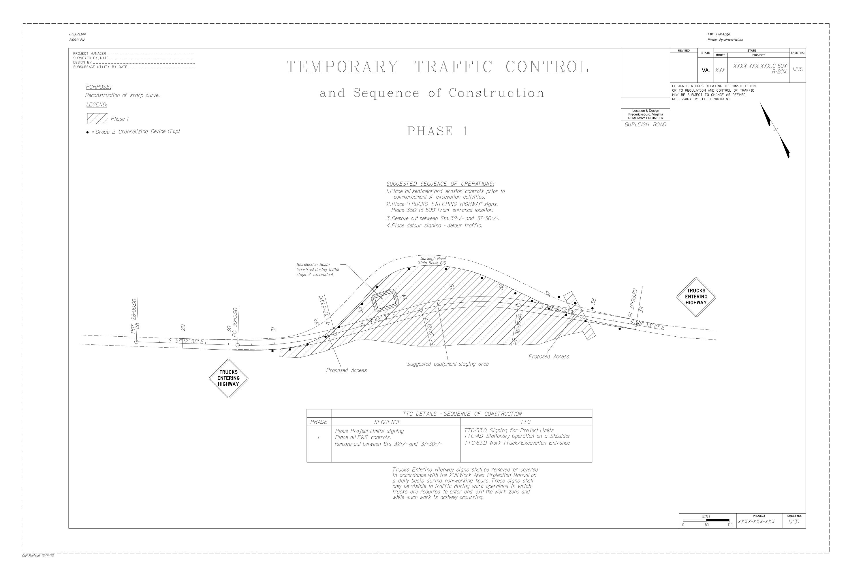
FIGURE 2H - 13 SAMPLE TRAFFIC MAINTENANCE PLAN (TMP) SHEET
