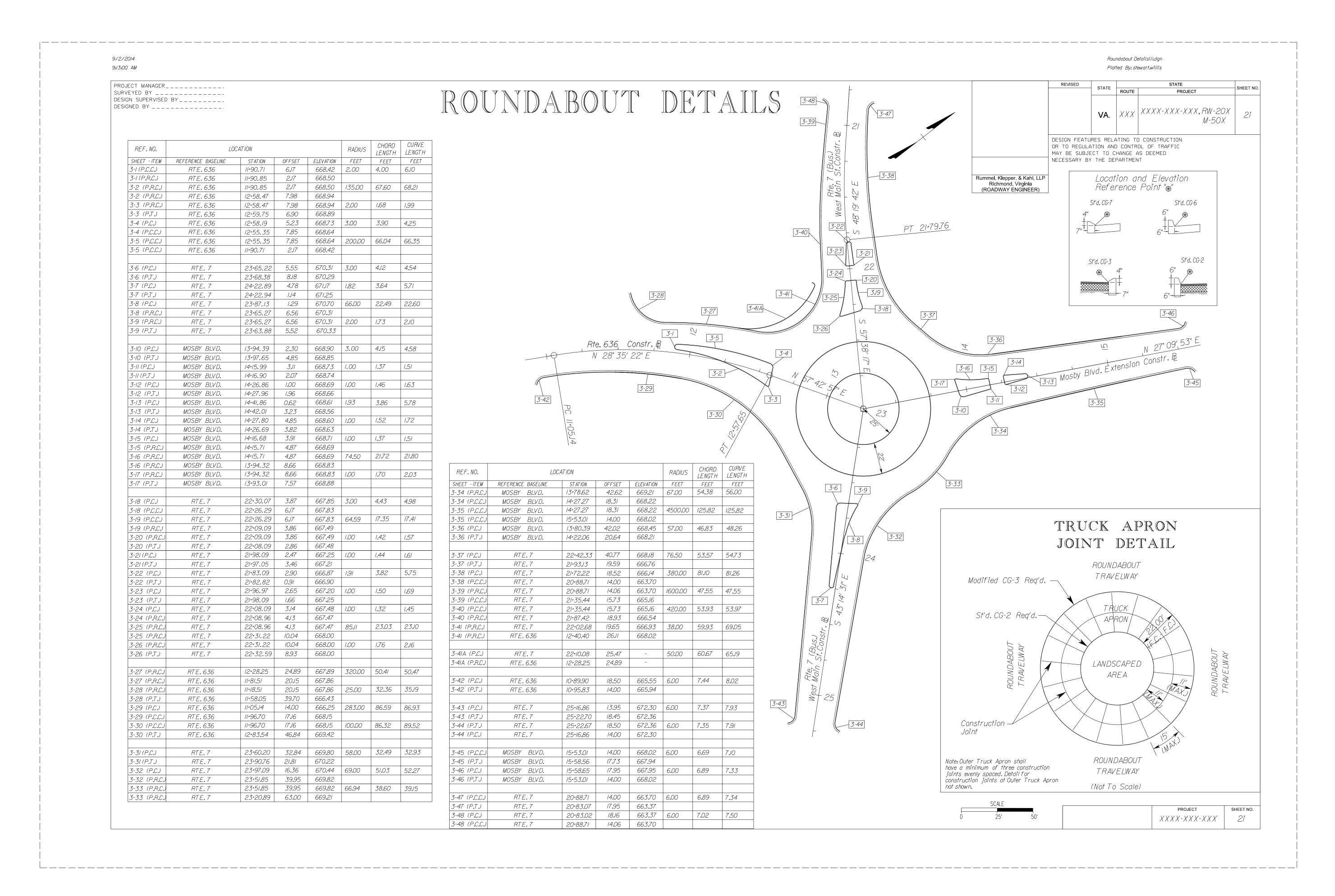
FIGURE 2H - 27 SAMPLE ROUNDABOUT DETAIL SHEET
