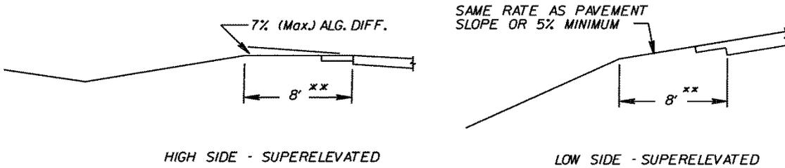
\*\* WHERE MAINLINE IS 6 OR MORE LANES GRADED SHOULDER WIDTH IS TO BE THE SAME AS THAT SHOWN FOR FILL SHOULDER FOR INDEPENDENT GRADING.
