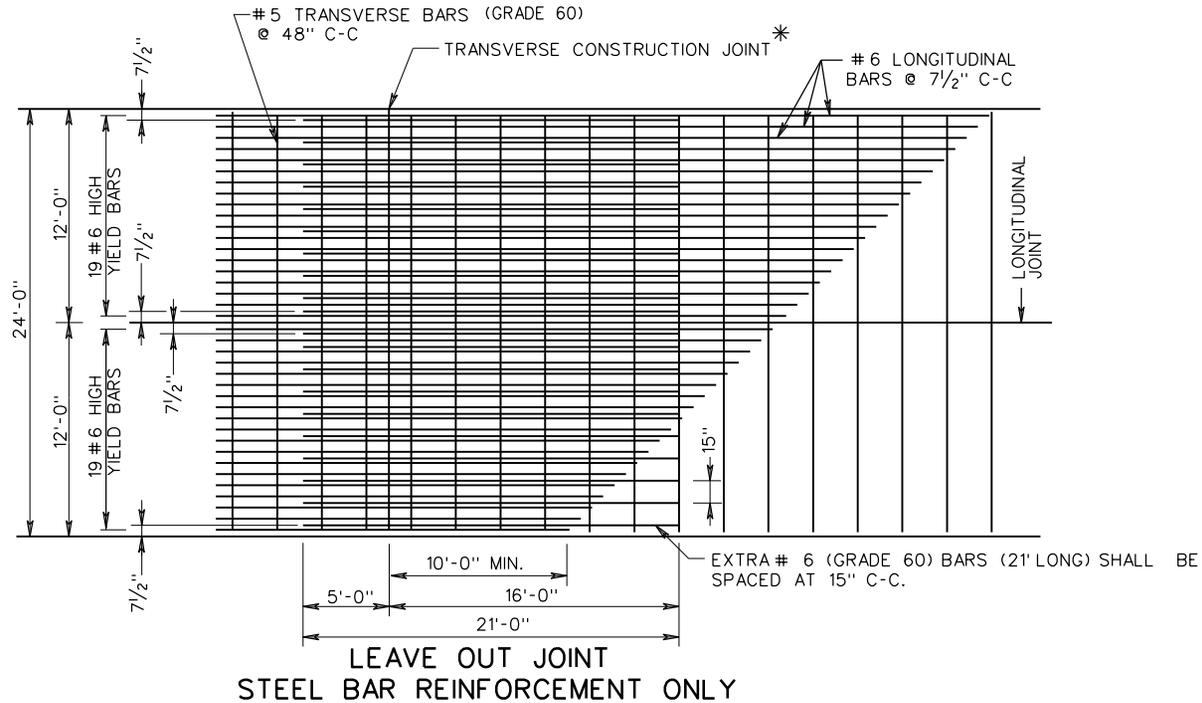
\* LONGITUDINAL STEEL TO CONTINUE THROUGH JOINT.
