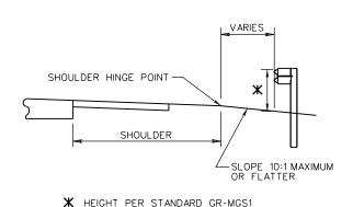
MEASURING GUARDRAIL HEIGHT ON FRONT SLOPE RELATIVE TO SHOULDER HINGE POINT
