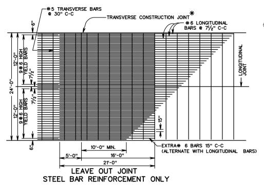
\* LONGITUDINAL STEEL TO CONTINUE THROUGH JOINT. EXTRA # 6 (GRADE 60) BARS (21'LONG) SHALL BE SPACED AT 15" C-C.
